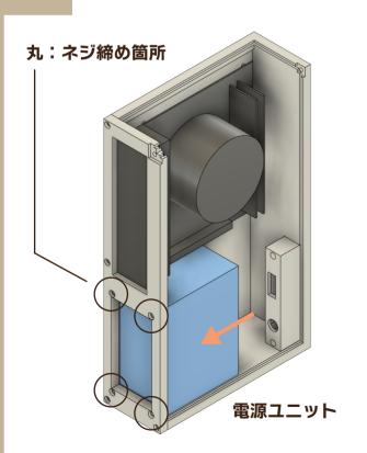
「バックパネル」のネジ穴に合うように、電源ユニットを 仮置きします。固定には、付属品 B のネジを用います。
