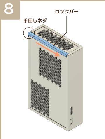
「ロックバー」先端の突起を「フロントパネル」上部内側の窪み に差し込み、バックパネル側のネジ穴を使用し、手回しネジで 「ロックバー」を固定します。これにて完成です。
