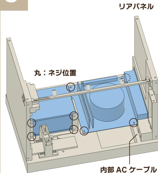
マザーボードは付属品 A のネジ、電源ユニットは付属品 B のネジを用いて固定します。「リアパネル」下部にある「内部 AC ケーブル」を電源ユニットへ接続します。
