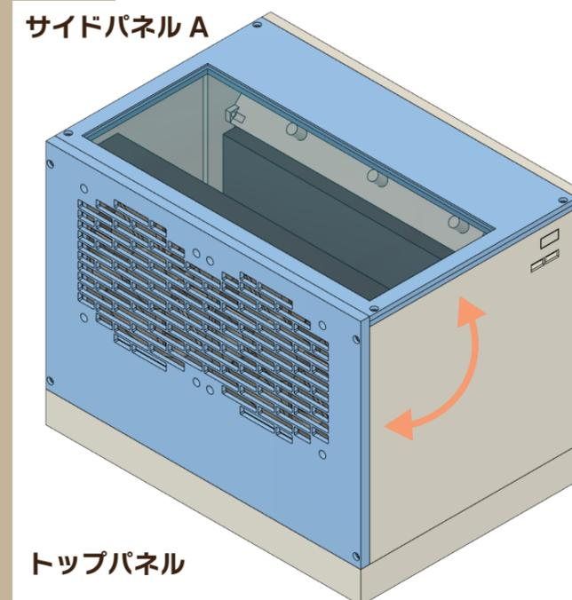
「トップパネル」と「サイドパネル A」は入れ替え可能となっております。見栄え重視の場合は手順 7 の形態。エアフロー（冷却能力）重視の場合は手順 8 の形態をお勧めします。お好きな形でパネルを固定したら、完成です。
