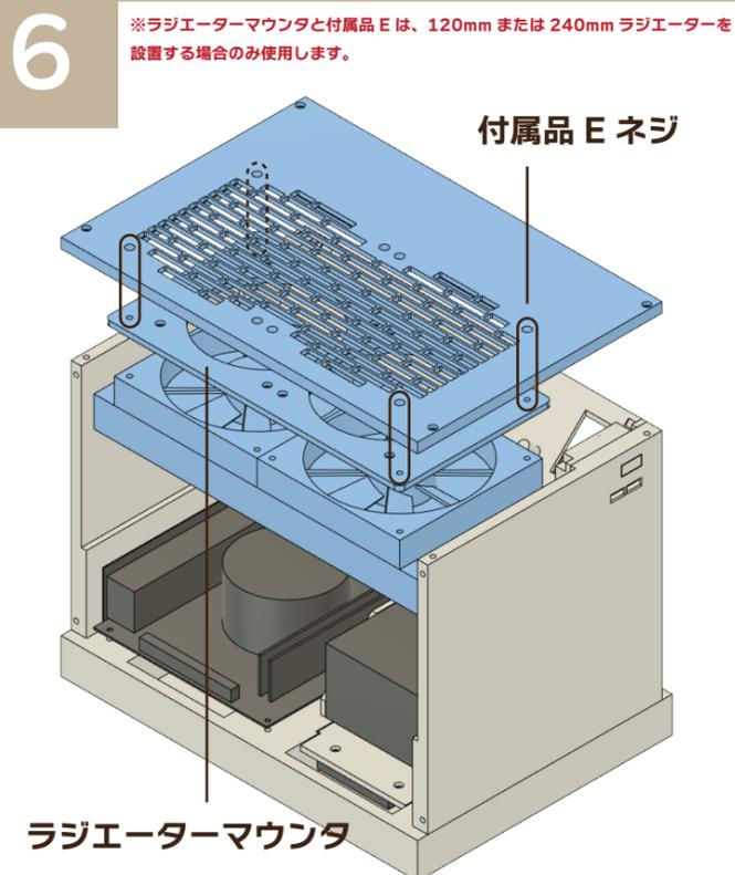
「トップパネル」に 280mm または 140mm ラジエーターを取り付けます。120mm または 240mm ラジエーターを取り付ける場合のみ、「ラジエーターマウンタ」と付属品 E のネジを使用します。ファンのみの取り付けも可能です。吸気推奨。
